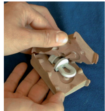
Fig. 445. Los moldes en bloque flexibles sólo se realizan sobre pequeñas piezas con retenciones, pues el material de moldeado es bastante caro.
