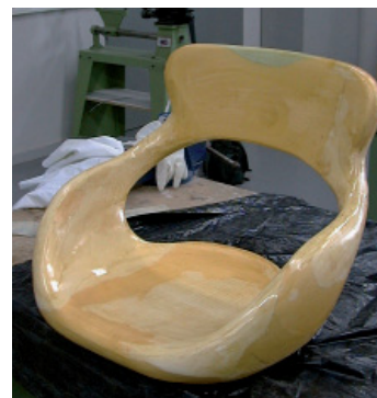
Fig. 520 Este complejo modelo de asiento, realizado con poliestireno extrusionado, está preparado para realizar el molde de escayola. Diseño de Eva Campo (1999).
