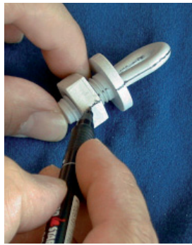
Fig. 421. Hay que marcar la línea de junta antes de introducirla en el lecho.
