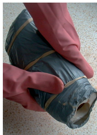
Fig. 463. Para evitar problemas, es aconsejable utilizar guantes y envolver el molde con plástico antes de la colada de cera. Si no se toma esta precaución no pasa nada con moldes pequeños, pero vale la pena prevenir riesgos.
