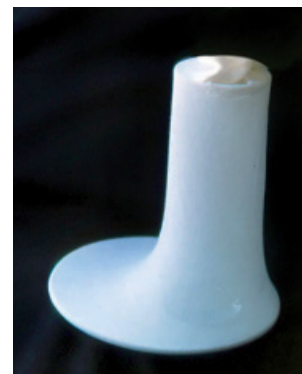
Fig. 131. La tela elástica sobre el vaso y el plato transforma las aristas de unión en una superficie continua, de tipo orgánico.
