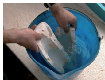
Fig. 458. El molde de escayola debe estar bien húmedo si se quiere reproducir una copia con cera fundida.
