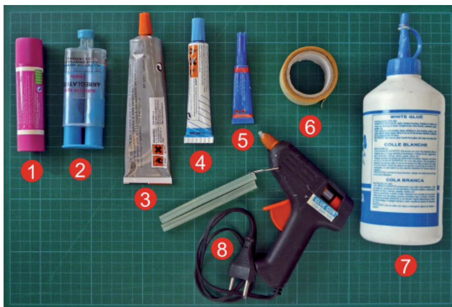
Fig. 387. Algunos adhesivos químicos y mecánicos útiles para las uniones con distintos materiales en la realización de maquetas.
