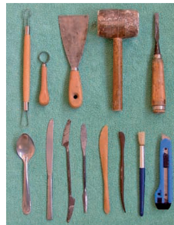
Fig. 473. Aquí se observan las herramientas más prácticas para realizar moldes y reproducciones. De izquierda a derecha y de arriba a abajo: vaciadores, espátula, maza, formón, cuchara sopera, cuchillo de punta redonda, espátulas para yeso, palillos de plástico para modelado, una brocha y un cúter. Indudablemente, se puede prescindir de alguna de ellas, ya que cada uno acaba por tener sus preferencias.
