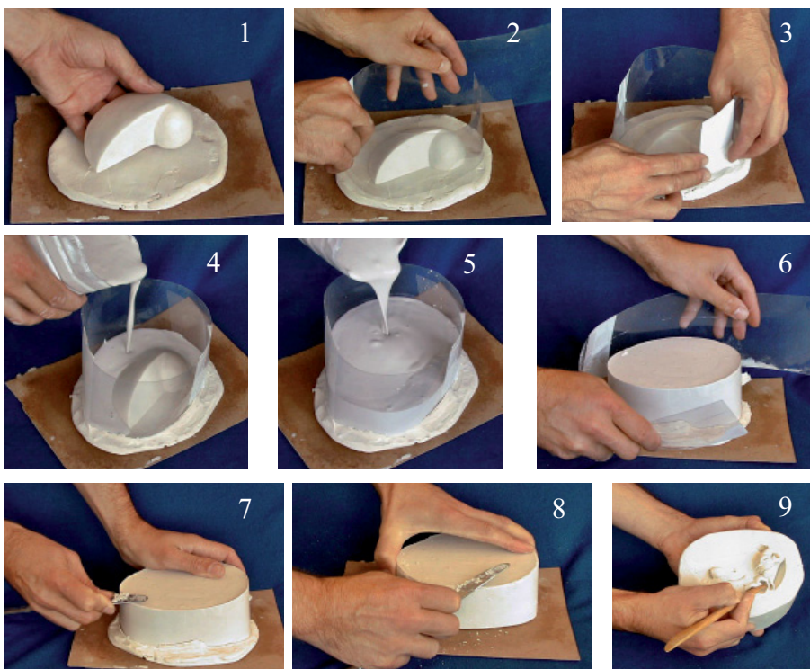
Fig. 441. Fases de la elaboración de un molde en bloque de una sola pieza a partir del modelo de plastilina.
