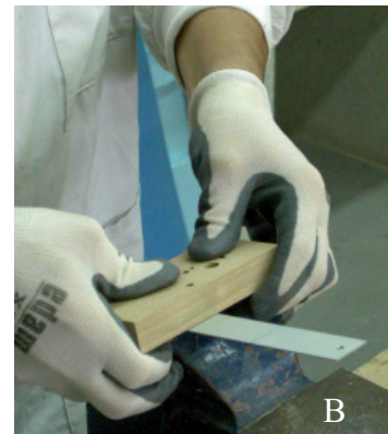
Fig. 308. Método para realizar una esquina curva con ayuda de un molde o un canto curvo.
