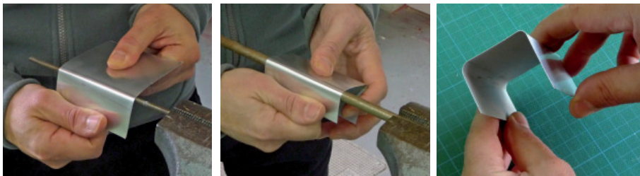
Fig. 309. Procedimiento para realizar pliegues curvos mediante el uso de varillas o tubos de distinto diámetro sobre una plancha metálica.
