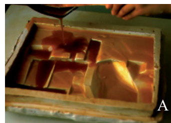
Fig. 458. El molde de escayola debe estar bien húmedo si se quiere reproducir una copia con cera fundida.
