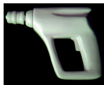
Fig. 480. Modelo de taladro realizado con espuma de poliestireno. Diseño de Raúl Felici (1996).
