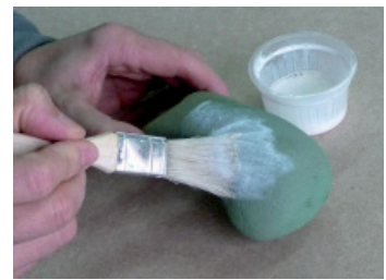
Fig. 524. Aplicación de látex disuelto en un poco de agua, después de dar forma al poliuretano hidrófilo.
