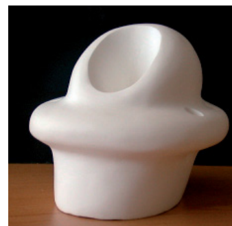
Fig. 509. Un acabado fino sólo se consigue con lijas de agua, pero sólo en la última fase, cuando el volumen y la superficie están resueltos. Soporte para cepillos de dientes (poliestireno masillado). Diseño de Raquel Porcar (1999).
