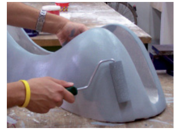
Fig. 512. A la hora de pintar un modelo de grandes dimensiones se puede utilizar un rodillo.
