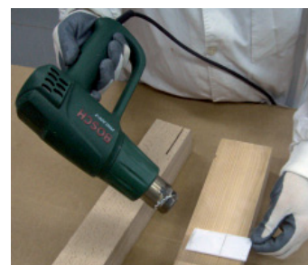
Fig. 322. La pistola de aire caliente (no un secador) puede proporcionar el calor necesario al termoplástico para ablandarlo.
