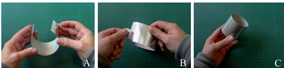
Fig. 311. Método para realizar un cilindro de chapa metálica. Previamente se habrá curvado sobre un tubo rígido, siguiendo el mismo proceso que el que se emplea para los pliegues curvos.
