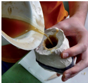
Fig. 423. Colada de cera líquida en un molde para reproducir una copia.
