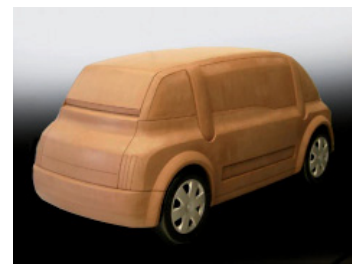
Fig. 236. Modelo de vehículo realizado mediante técnicas de modelado utilizando una arcilla especial. Diseño de José Luis Sanz y su equipo (2005).
