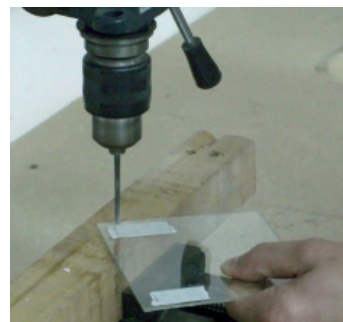
Fig. 329. Antes de taladrar hay que proteger la zona de perforación con cinta adhesiva y marcar el punto sobre ésta.
