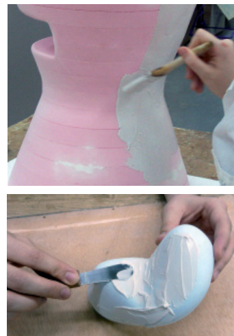
Fig. 507. La aplicación de la masilla puede hacerse con la brocha (A) o con espátula (B), depende de cada uno. Pero lo principal es aplicar capas finas que luego se dejan secar para ser lijadas cuando estén secas.
