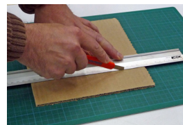
Fig. 284. Como en todos los materiales con cierto espesor, el corte no debe ser realizado con un sólo trazado de cúter.
