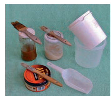
Fig. 472. Vale la pena emplear botes (mejor de cristal) para contener tapaporos, como la goma laca y los desmoldeantes, como la vaselina o la cera. Es imprescindible que cada producto tenga asignado un pincel o una brocha, porque así se evitan mezclas inoportunas. También son muy útiles los botes de plástico de distintos tamaños, que se pueden conseguir a partir de botellas de deshecho, así como algún dosificador.
