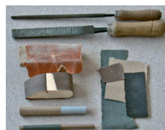
Fig. 490. Algunas de las herramientas más útiles para trabajar con las espumas rígidas son muy comunes y sencillas: escofinas, lijas de distintos granos y soportes variados para adaptar las lijas.
