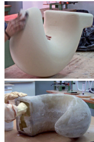
Fig. 521. Tres fases del prototipo de taburete-balancín realizado con espuma de poliuretano forrada con resina y fibra de vidrio: la configuración del olumen (A), la aplicación del plástico reforzado (B) y el prototipo terminado y pintado (C). Diseño de Santiago Isidro (2006).
