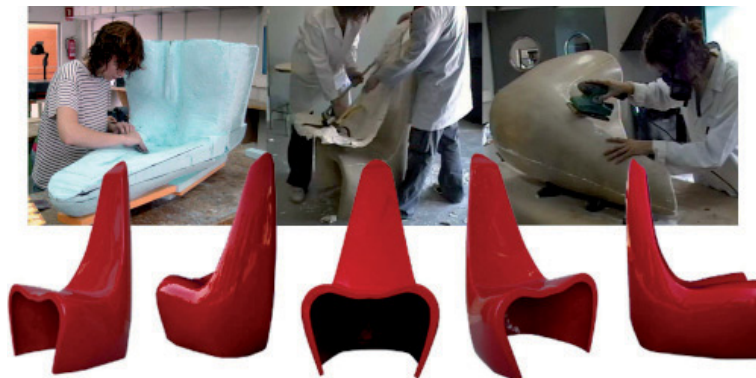
Fig. 194. Imágenes del proceso seguido para realizar el prototipo de resina Silla Saksu . Diseño de Leire Vicent (2005).
