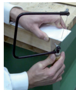
Fig. 324. La sierra de marquería también es útil para cortar láminas finas de plástico.
