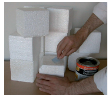
Fig. 513. Encolado con pegamento específico de distintos bloques de poliestireno expandido para construir un bloque mayor.
