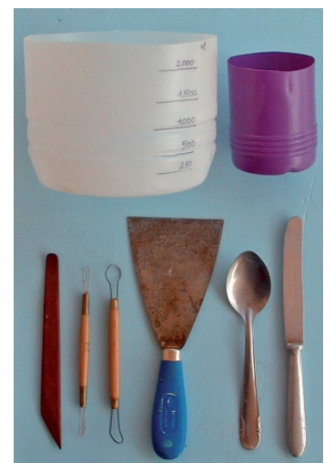
Fig. 434. Los utensilios para preparar moldes pueden ser todo lo variado que uno quiera, pero una cuchara, un cuchillo y un cuenco para preparar la escayola, pueden ser suficientes.
