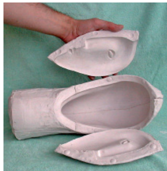
Fig. 425. A pesar de tratarse de un molde de cinco piezas, su encaje perfecto no requiere la presencia de un contramolde, pues no es siempre necesario.
