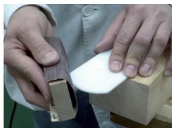
Fig. 327. Usar una lija a mano ayuda a igualar superficies y a eliminar las posibles rebabas después de un corte irregular.
