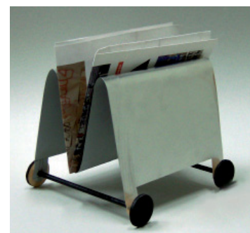
Fig. 310. La lámina metálica de aluminio de poco espesor se maneja casi igual que la cartulina, pero mantiene mejor la forma. Maqueta preliminar de un revistero con ruedas. Diseño de Miriam Arandes (2004).
