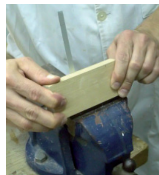
Fig. 383. Procedimiento más seguro para doblar o pegar una varilla o un perfil metálico.
