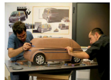
Fig. 403. Para el diseño de carrocería se emplean, a veces, modelos de arcilla especial. Diseño de vehículo de transporte público. Diseño de José Luis Sanz y su equipo (2005).
