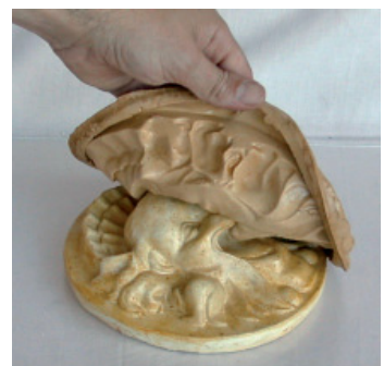
Fig. 418. Cuando un objeto tiene muchas retenciones, es preferible realizar un molde flexible.
