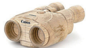
Fig. 341. Modelo volumétrico de unos prismáticos realizados con madera de balsa. Canon Camera Museum ( www.canon.com ).
