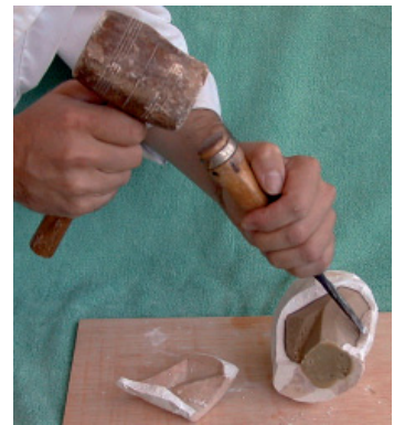
Fig. 447. El molde perdido es único y para extraer la copia se debe destruir con cuidado para no dañarla.
