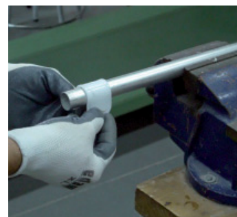
Fig. 331. Después de aplicar calor, se puede curvar la pieza de plástico con el diámetro que sea necesario apoyándola sobre un tubo que actúe de molde.
