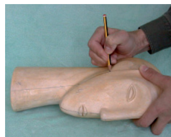
Fig. 411. Trazado de la línea de junta en un modelo de escayola antes de iniciar el molde.
