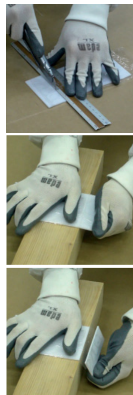
Fig. 323. Método simple para cortes rectos en planchas de plástico con ayuda de un cúter. Los guantes en esta acción son imprescindibles.
