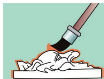
Fig. 430. Aplicar demasiado desmoldeante puede desembocar en un molde o en una reproducción poco fiel al original, ya que este exceso eliminará la textura de la superficie original e incluso generará volúmenes que desvirtuarán la forma.
