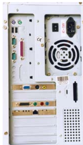
Figura 4.26. Vista trasera de la caja: en la parte superior izquierda distinguimos, de arriba a abajo, dos puertos PS2 para teclado (morado) y ratón (verde), dos puertos USB, dos puertos serie (en verde) y un puerto paralelo (magenta)
