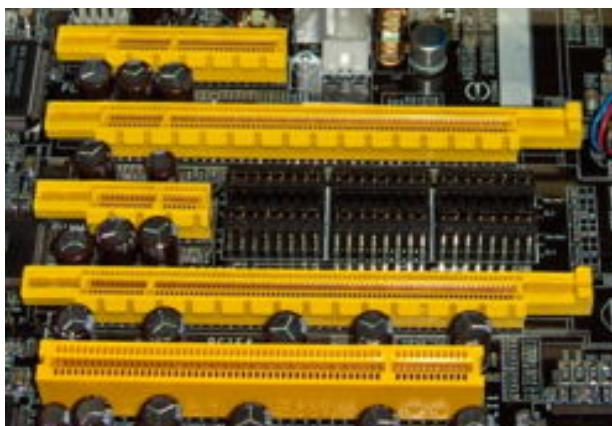
Figura 4.35. Conectores para el bus PCI Express en la placa base de un PC
