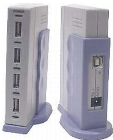
Figura 4.36. Un hub (“ladrón”) USB que permite la conexión de varios dispositivos USB al único puerto al que se conecta
