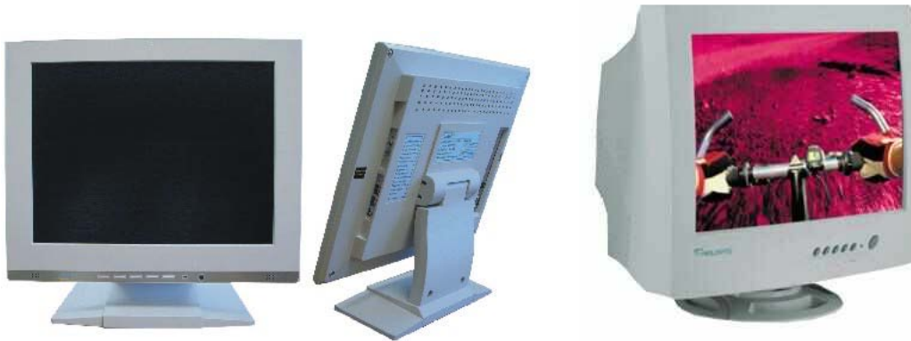
Figura 4.39. A la izquierda, un monitor de pantalla plana (TFT). A la derecha, un monitor de rayos catódicos
