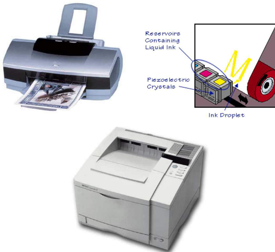
Figura 4.51. Arriba: a la izquierda, una impresora de inyección de tinta; a la derecha, esquema de funcionamiento del mecanismo de inyección de tinta. Abajo, una impresora láser
