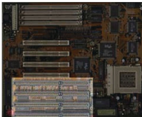
Figura 4.32. Los conectores para el bus ISA son fáciles de identificar en la placa base: son más grandes
