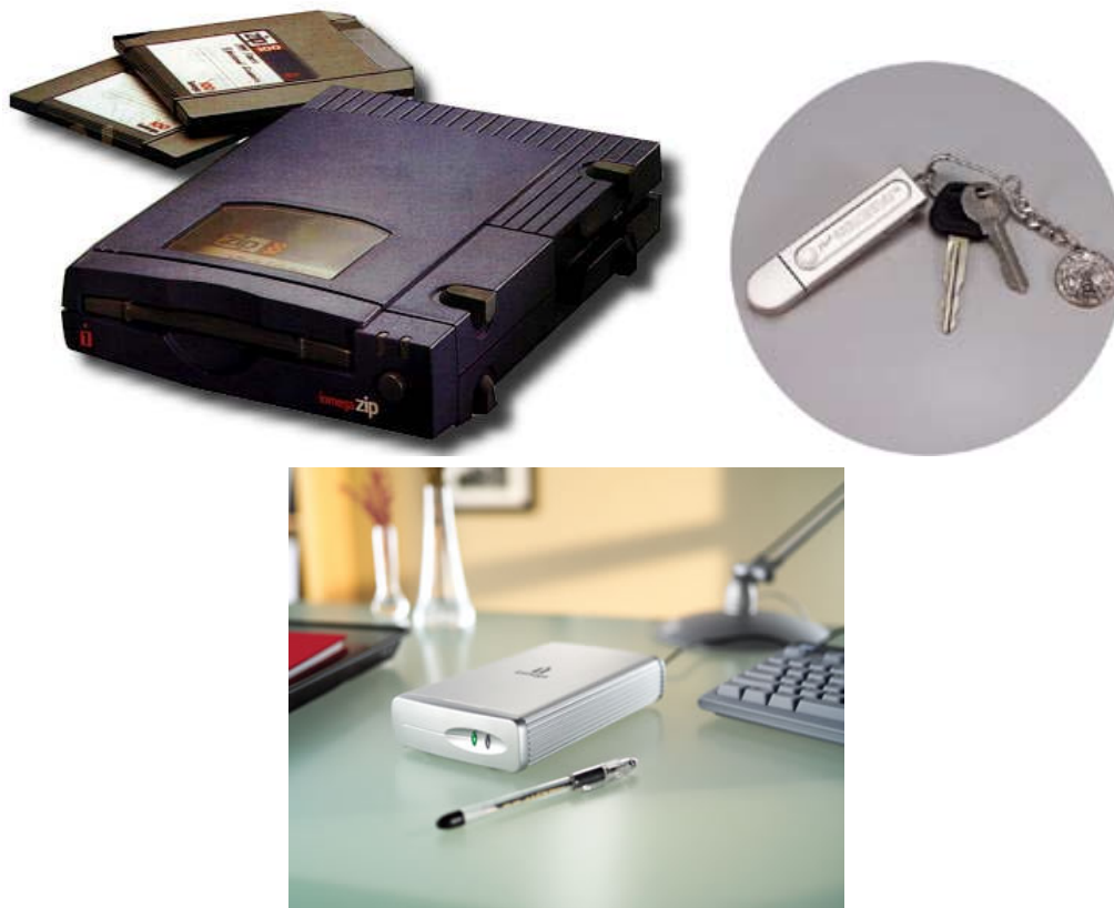
Figura 4.48. Arriba a la izquierda, una unidad ZIP y sus cartuchos. A la derecha, un pendrive USB. Abajo, un disco externo USB 2.0
