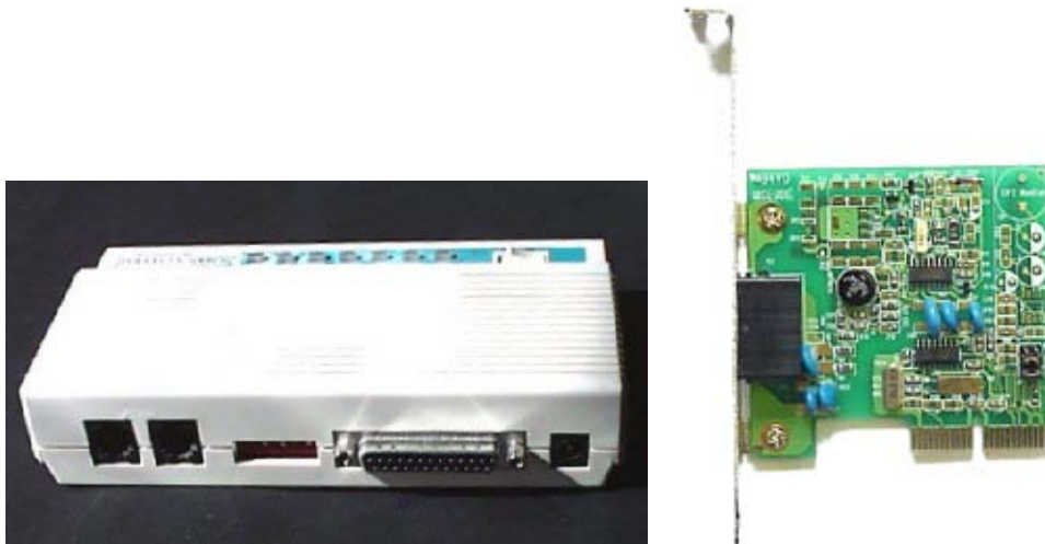
Figura 5.13. A la izquierda podemos ver la imagen de un módem telefónico externo. A la derecha tenemos una tarjeta PCI interna que desempeña la funcionalidad del módem telefónico
