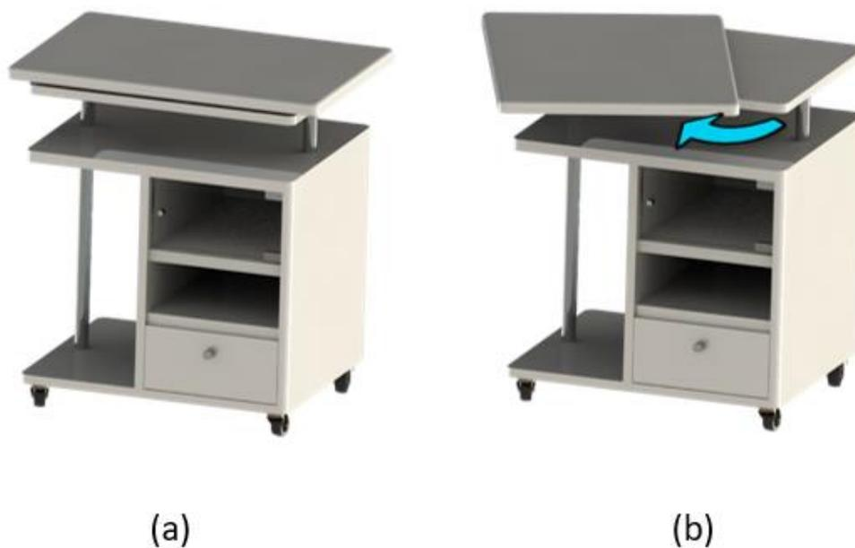
**Figura 183.** Funcionamiento del mueble: (a) mueble cerrado (b) giro de tabla superior.
