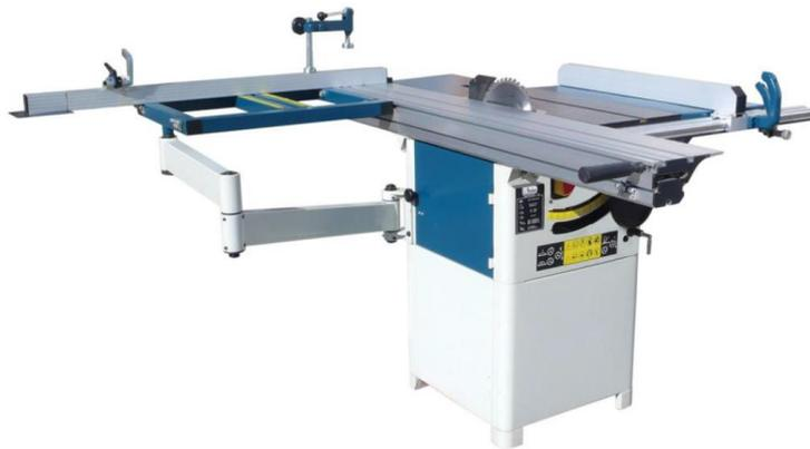
**Figura 33.** Mesa con sierra circular para el corte de la madera.
