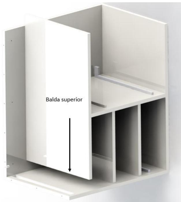
**Figura 54.** Montaje de balda superior.
