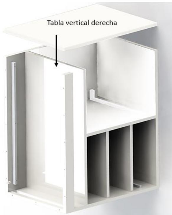
**Figura 56.** Montaje de tabla vertical derecha.
