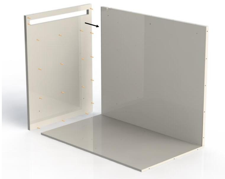
**Figura 50.** Unión de tabla vertical izquierda con tabla base y fondo.
