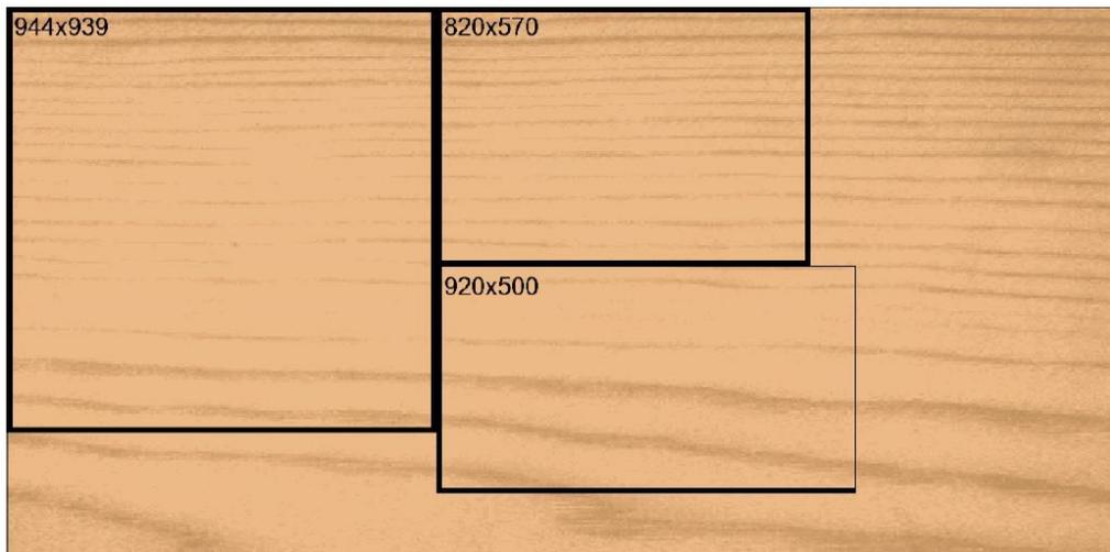
**Figura 138.** Distribución geométrica de piezas de 3,0 cm de grosor.
