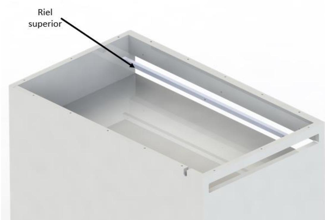
**Figura 58.** Montaje de riel superior.
