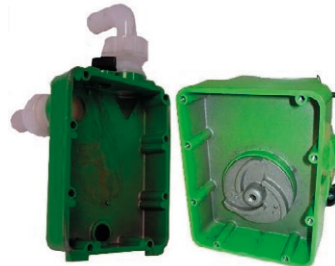
Ilustración de la función de bomba hidráulica: rodete y carcasa
