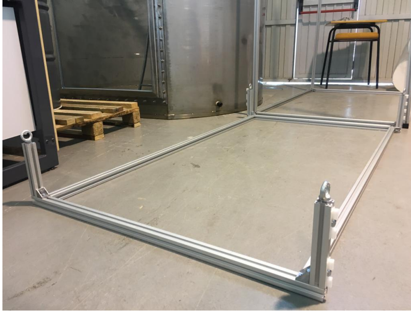
Figura 25. Estructura sumergible deslizante
