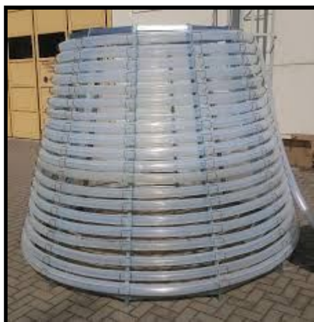
Imagen 14: Fotobiorreactor en forma de árbol de Navidad
