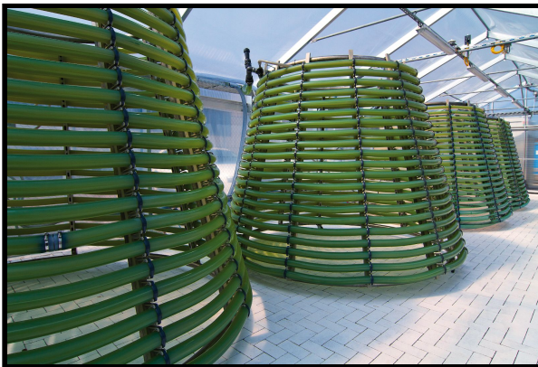
Imagen 10: Fotobiorreactor en forma de árbol de Navidad
