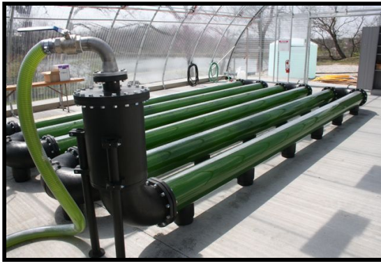
Imagen 8: Fotobiorreactor en serpentina plano
