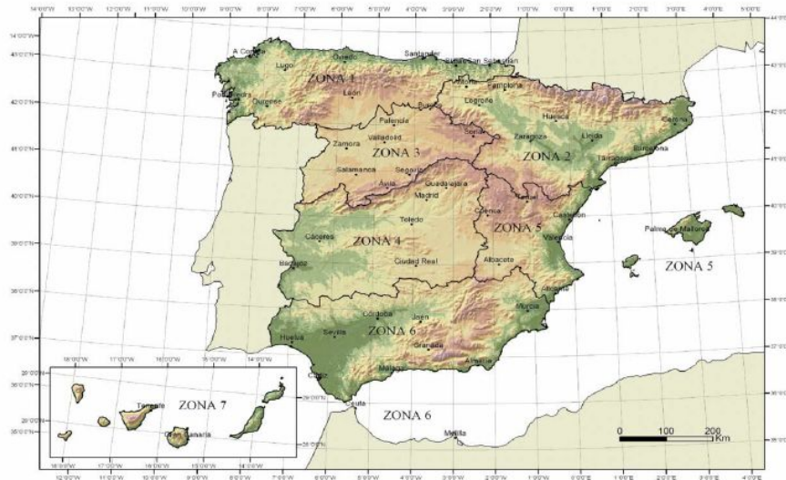
Imagen 54: Zonas de sobrecarga de nieve en un terreno horizontal
