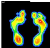
Mapa de presiones plantares medidas con los sensores de la plantilla
