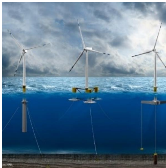
Figura 10 - Cimentaciones flotantes para aerogeneradores marinos. Fuente: Energy.gov
