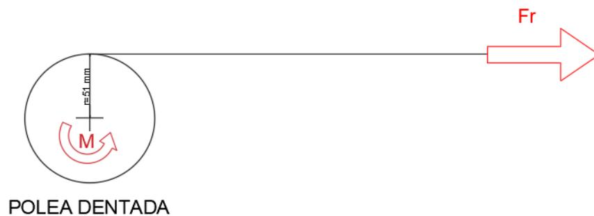
Ilustración 54: Diagrama simplificado polea-correa
