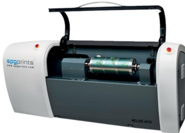
Figura 5: Torno láser con rodillo aspirante
