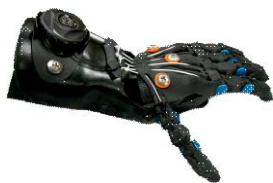
Figura 2: Prótesis pediátrica modelo Cyborg Beast. Obtenida de Zuniga et al. [11].
