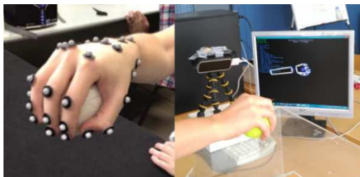
Figura 3: Registro de la postura 2 realizado con el sistema Vicon (izquierda) y con el LeapMotion (derecha).
