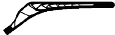
Fig. 4. Resultado del proceso de optimización topológica.
