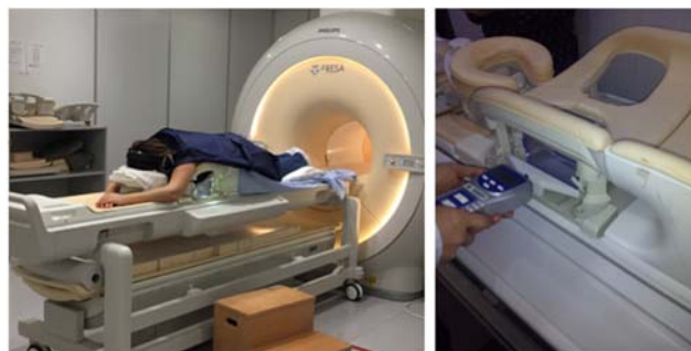
Fig. 2: MRI de la mama en el dispositivo de biopsia por resonancia magnética (izquierda), posición para medida de la fuerza ejercida por las placas (derecha).
