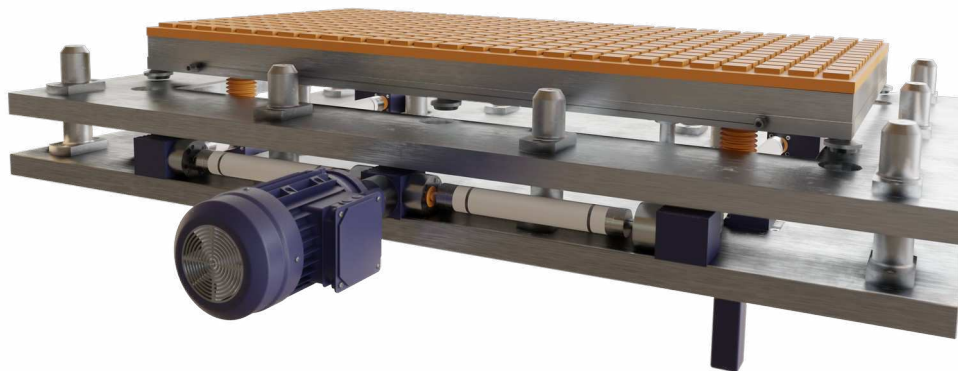
Figura 47: molde con el sistema expulsor, la base salvabanco, y la base del expulsor
