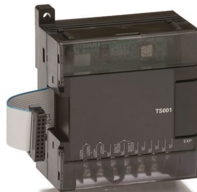
Figura 58: Modulo de expansión CP1W-TS001 par CPL1
