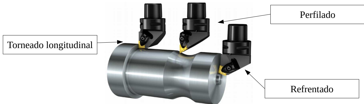
Figura 81: Vista general de las operaciones de torneado mas comunes
