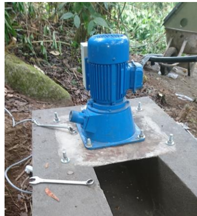
Imagen 2.13.- Turbina y base.
