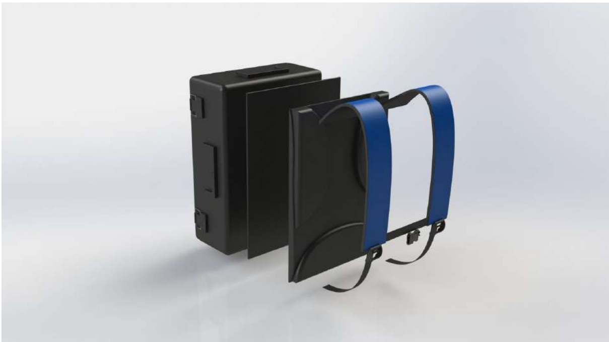
Figura 1.24.. Montaje hombreras y espuma espalda
