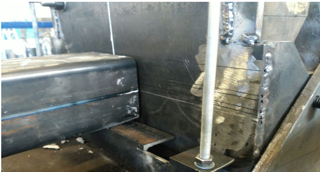
Figura 30. Control de las excentricidades.
