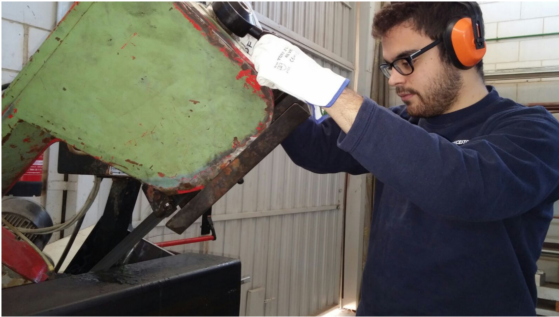
Figura 23. Proceso de cortado de los pilares de 6 m en la tronzadora.
