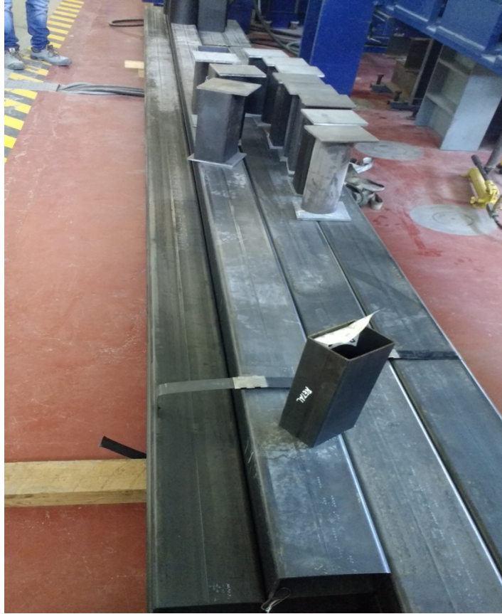
Figura 22. Tubos de 6 m de sección rectangular.
