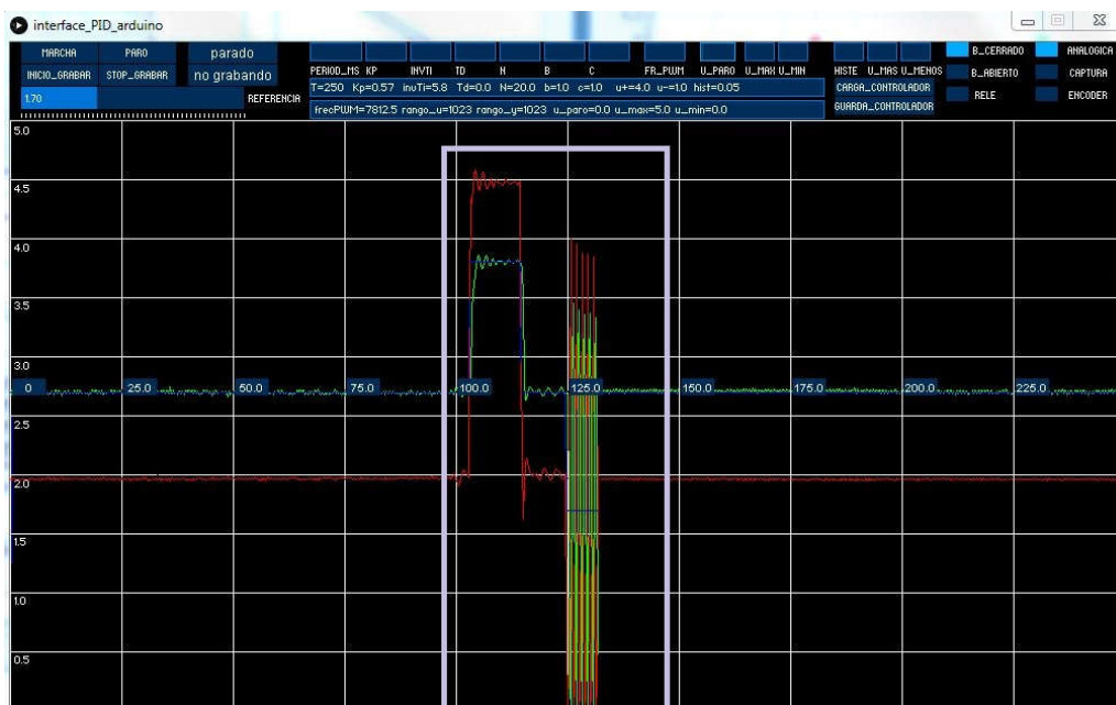
Figura 22. DATOS B.C. B12V + CAU con sobre oscilaciones
