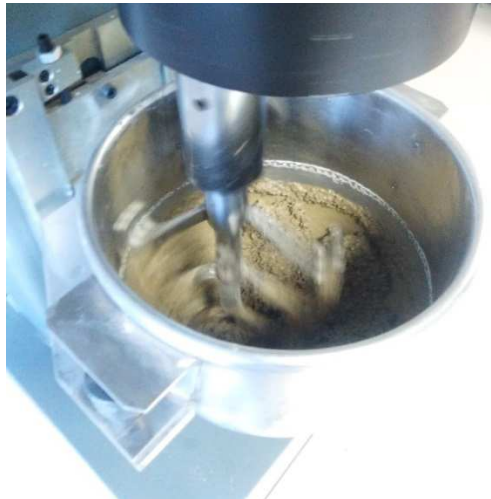
Figura 62: Amasado del mortero de cemento con la ayuda de una amasadora. Fuente propia.
