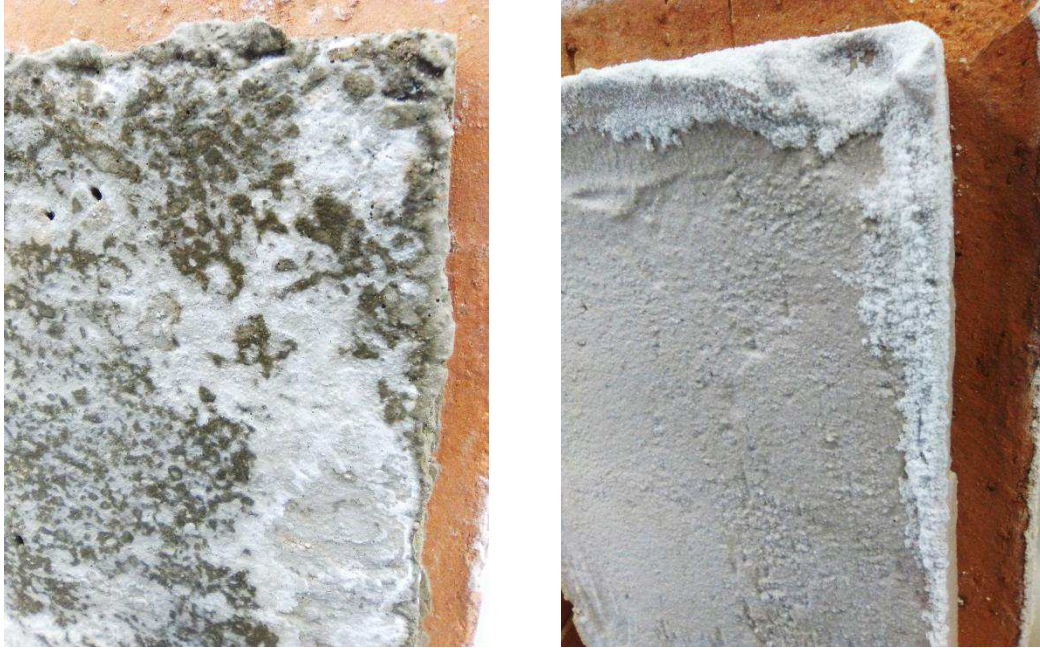
Figuras 84 y 85: Sales depositadas en los morteros de cemento (izquierda) y de yeso (derecha). Fuente propia.
