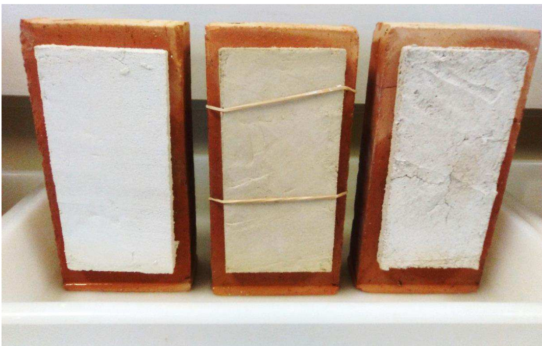
Figura 77: Probetas de mortero Weber, de Kerakoll y de cal tras 24 horas en contacto con agua.
