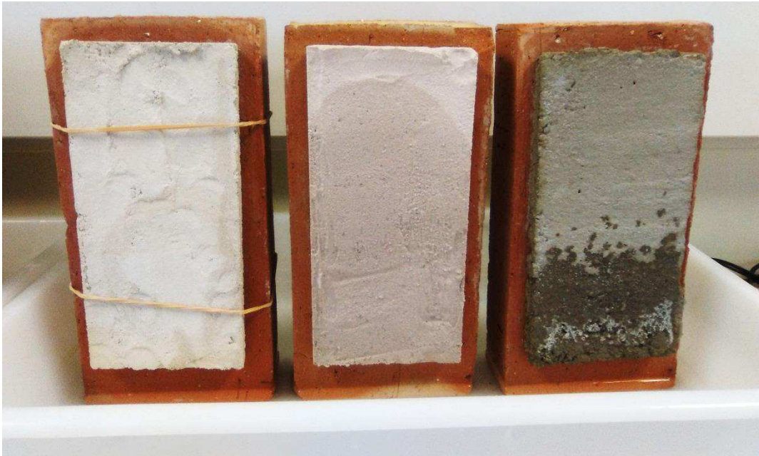
Figura 78: Probetas de mortero bastardo, de yeso y de cemento tras 48 horas en contacto con agua. Fuente propia.
