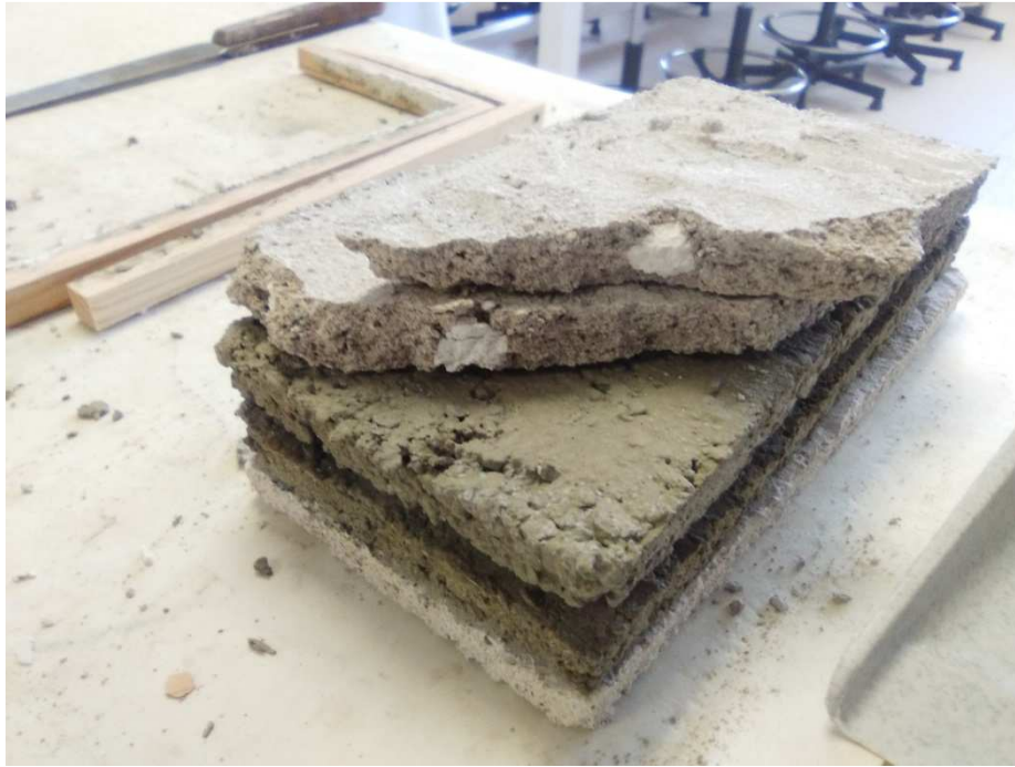
Figura 63: Probeta de cal aérea partida a causa de las concentraciones de cal. Fuente propia.
