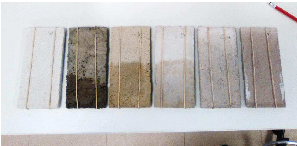
Figura 65: Comparación del nivel de agua entre las distintas probetas. Fuente propia.
