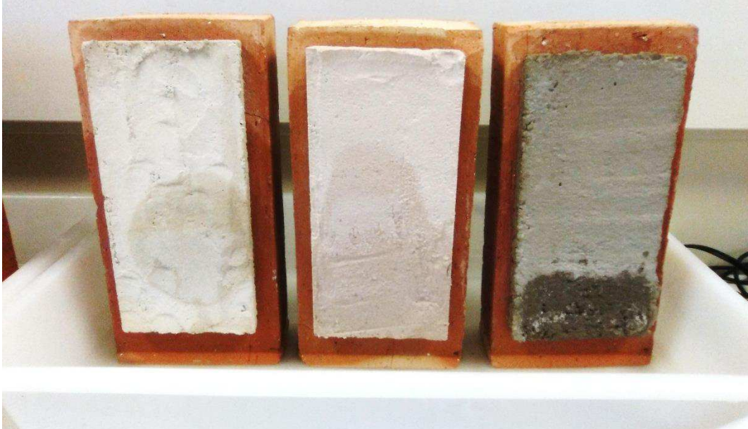
Figura 76: Probetas de mortero bastardo, de yeso y de cemento tras 24 horas en contacto con agua.
