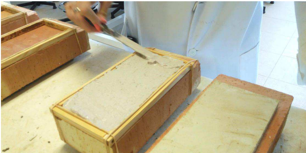
Figura 69: Colocación del mortero en el molde. Fuente propia
