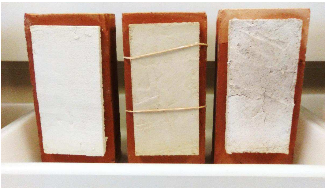
Figura 79: Probetas de mortero Weber, de Kerakoll y de cal tras 48 horas en contacto con agua. Fuente propia.
