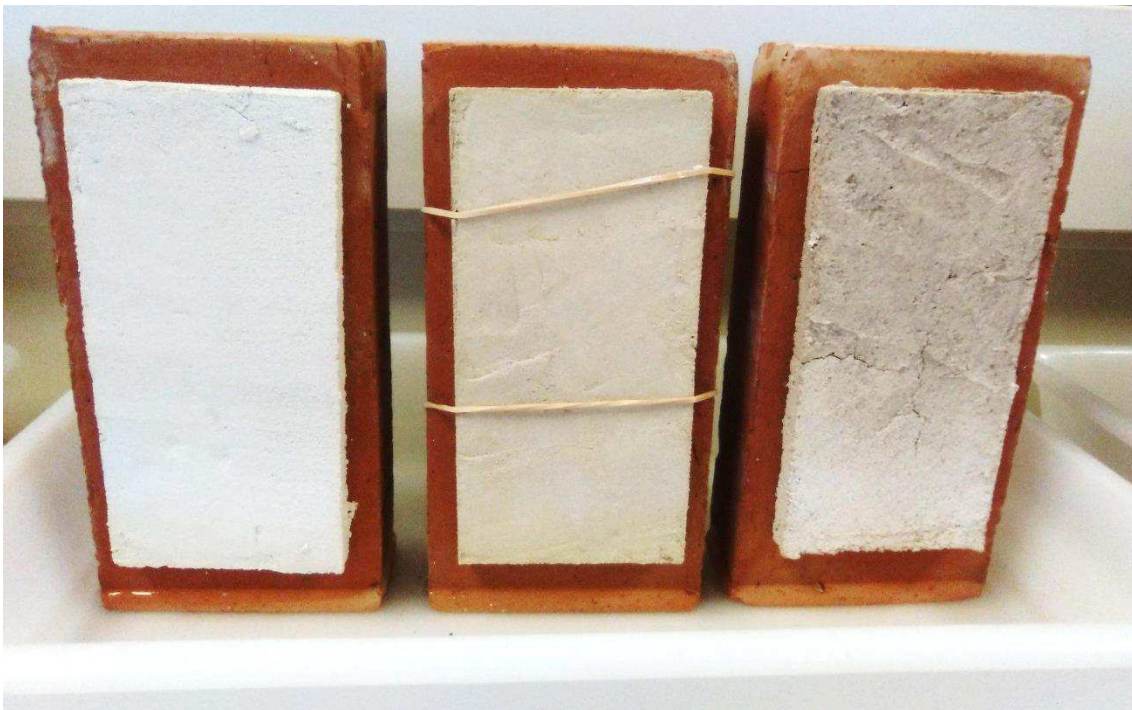
Figura 81: Probetas de mortero Weber, de Kerakoll y de cal tras 72 horas en contacto con agua. Fuente propia.
