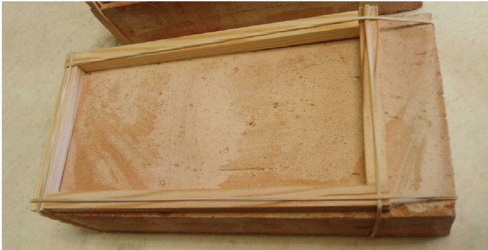
Figura 68: Moldes colocados sobre los ladrillos. Fuente propia.
