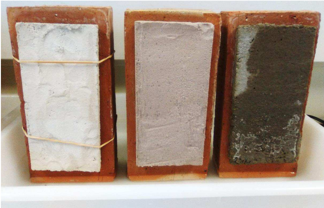
Figura 80: Probetas de mortero bastardo, de yeso y de cemento tras 72 horas en contacto con agua. Fuente propia.
