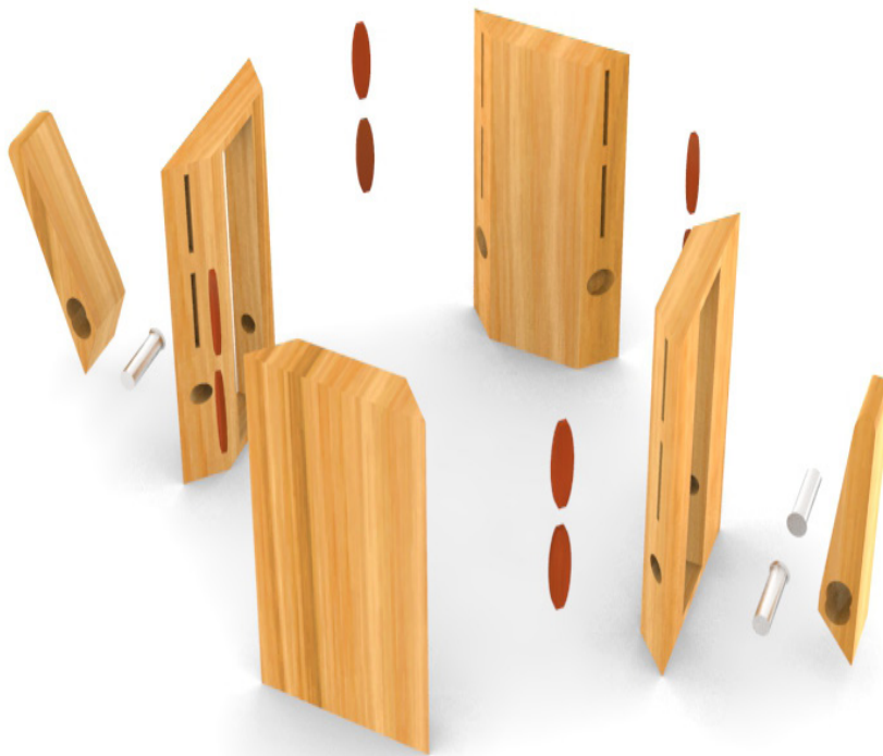
P17. Explosión módulo
