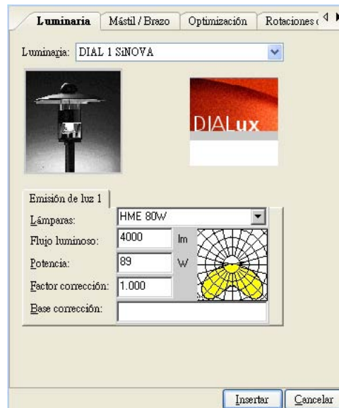
Ilustración 318 Insertar la disposición de calle – Luminarias
