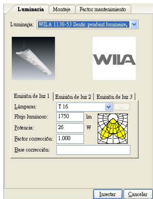
Ilustración 86 Configuraciones técnicas de luminarias con diferentes emisiones de luz
