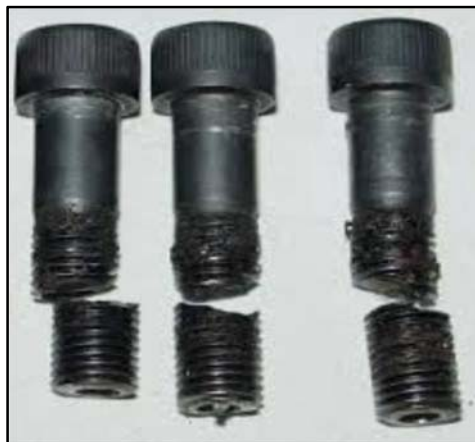
Figura 29: Modo de fallo a cortante
