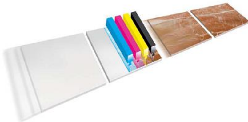
1.44 Esquema de una inyección de tinta para la decoración de un revestimiento.
