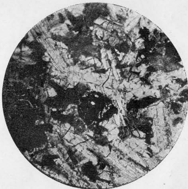
Fig. 4. Melafido de Alfondiguilla. — Luz ord. 40 d. prep. n.º 97, col. gral. erup. M. San Miguel. 1 labrador. 2 olivino limonitizado. 3 piróxeno alterado. 6 magnetita.
