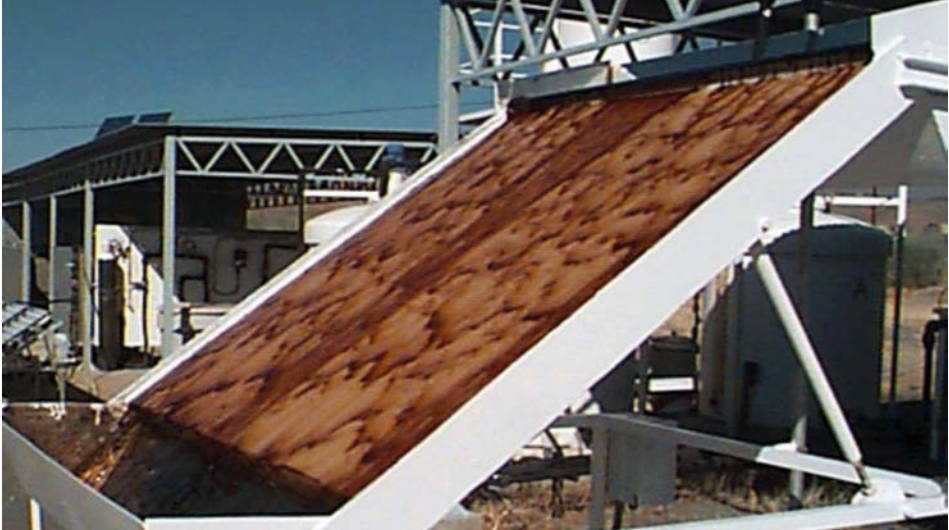
Figura 2.3. Fotorreactor sin concentración desarrollado durante los años noventa para aplicaciones de foto-Fenton
