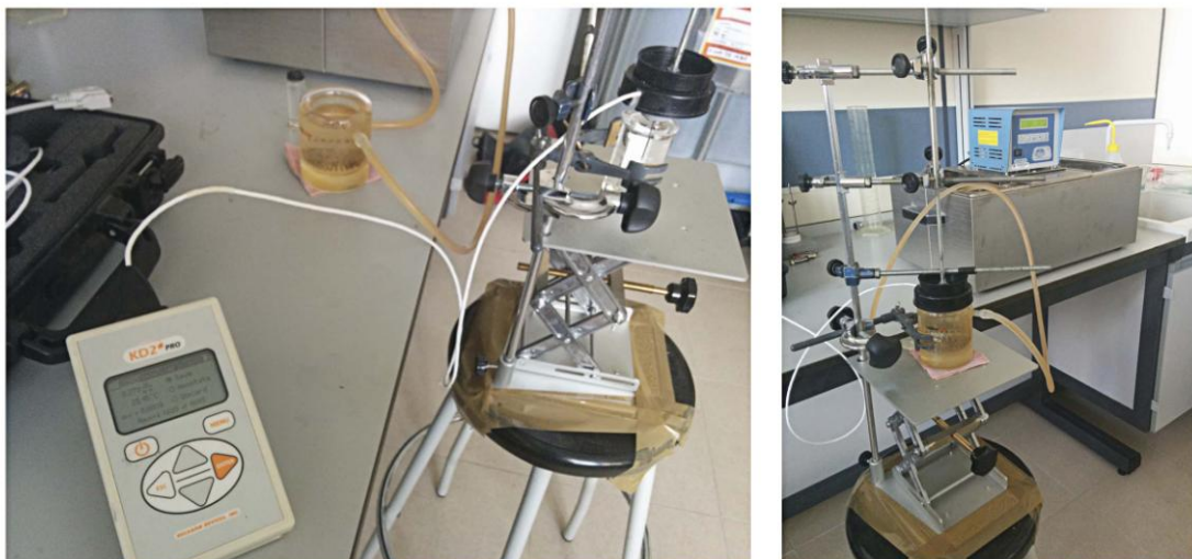
Fig. 12 Montaje realizado para la medición de la conductividad con el analizador térmico KD2 pro.
