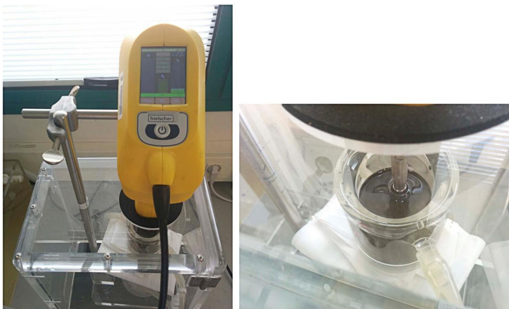
Fig. 8 Sonicación de las muestras con la sonda hielscher UP200Ht
