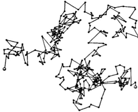
Fig. 1 Trayectoria de una partícula de pigmento amarillo suspendida en agua. Los puntos corresponden a la posición de la partícula cada 30 segundos (5).
