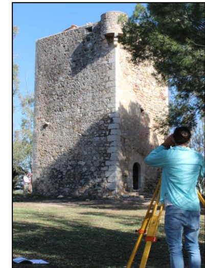
3. Fotografía de la toma de datos, utilizando la estación Total. Fuente: R.Verdoy
