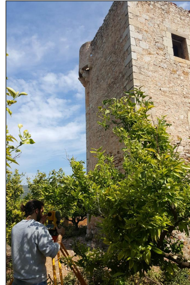
54. Fotografía tomada durante la toma de datos con estación total en la Torre dels Gats.
