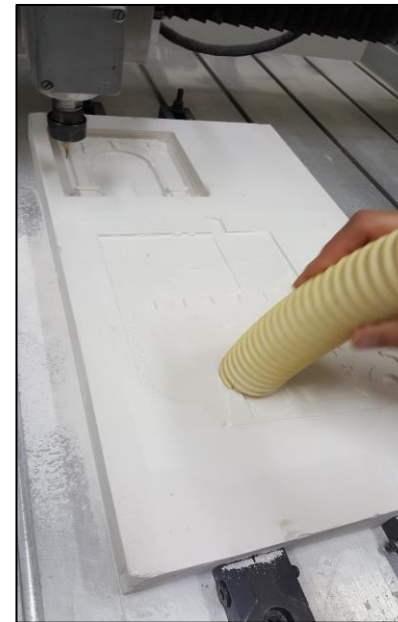
78. Fotografía del aspirado de los restos de escayola de la pieza.
