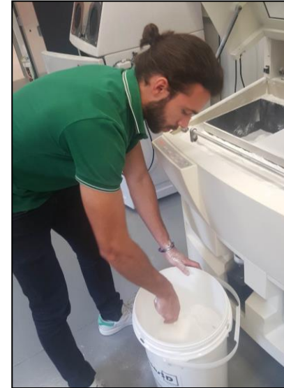
38. Fotografía del momento en que se arga la impresora 3D con polvo de yeso deshidratado, material con el cual se imprime el modelo añadiendo un conglomerante líquido.
