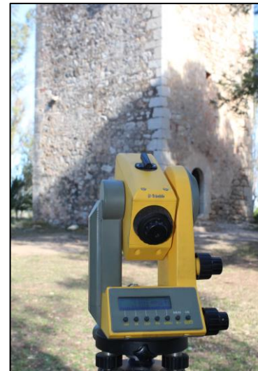
2. Fotografía de la estación total durante el proceso topográfico en Torre la Sal. Fuente: R.Verdoy
