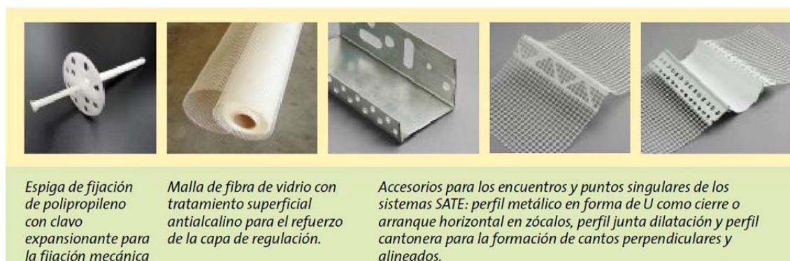
Elementos del sistema SATE (ISOVER, 2015)
