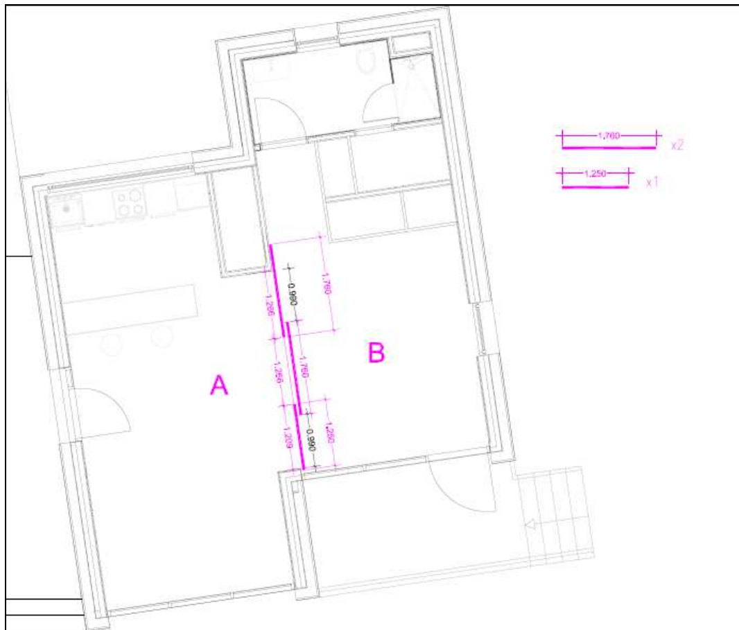
Imagen 32. Análisis de los estores a instalar de entre los que se disponía / [EP]
