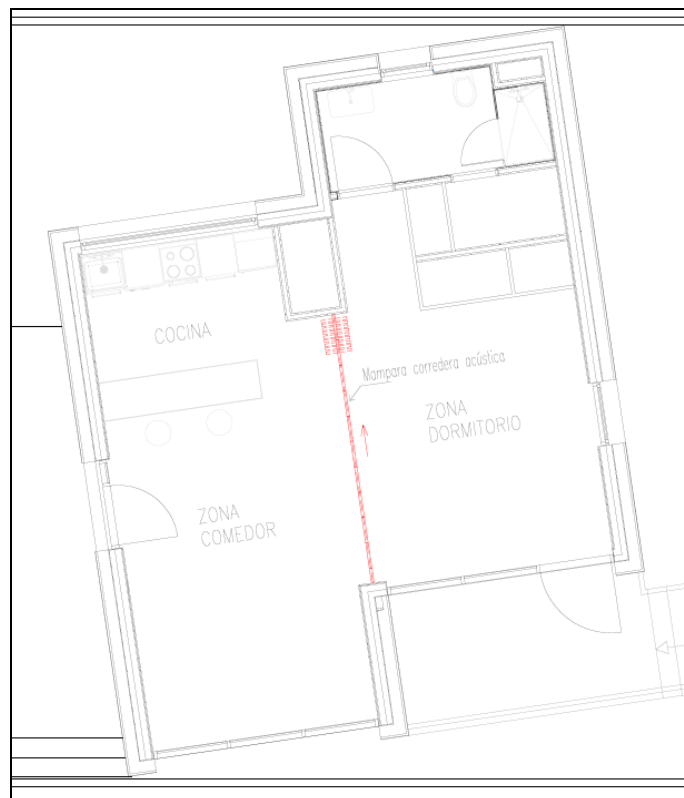
Imagen 31. Estudio de la solución con mampara acústica plegable / [EP]
