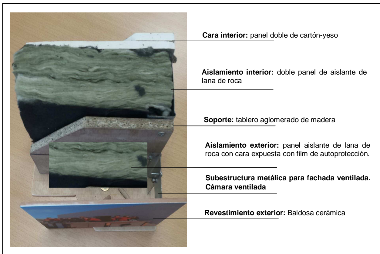
Imagen 22. Composición de las fachadas cerámicas / [EP]
