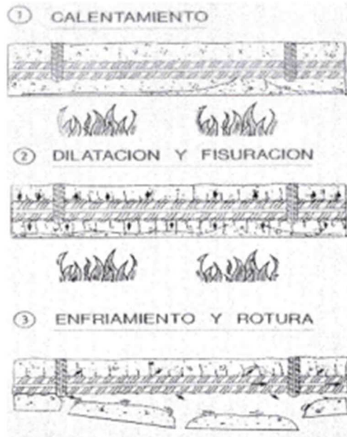
Fotografía 25. Proceso de pérdida de adherencia
