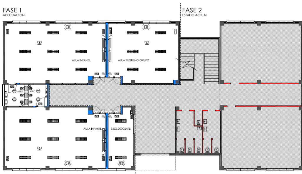
Plano de proyecto. Instalación eléctrica fase 1
