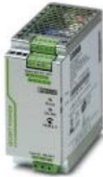
Fuente de alimentación QUINT POWER conmutada en primario para montaje sobre carril con tecnología SFB (Selective Fuse Breaking), entrada: monofásica, salida: 24 V DC/10 A
