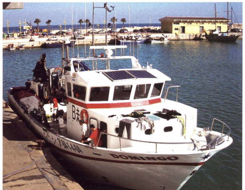
Traïna de V. i La Geldrú con placas solares sobre el puente
