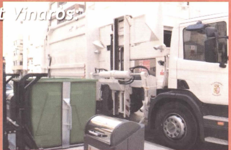
Recollida automatitzada d'escombreries
