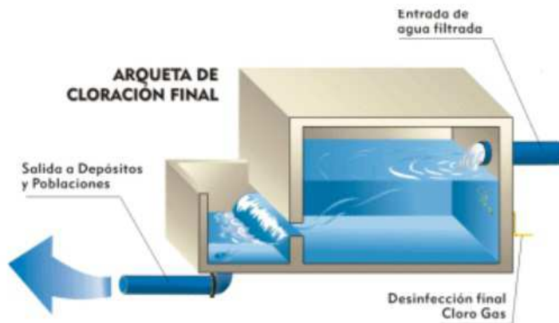
FIGURA 2.24 Proceso desinfección con cloro gas
