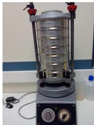
Figura 9. Procedimiento ensayo tamizado: a) Material seco; b) Tamizadora.
