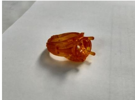
Ilustración 15 – Impresión con tecnología SGC
