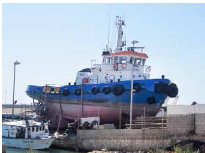
Remolcador a varadero para limpieza de fondos
