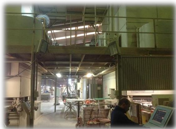
En la zona de secado las baldosas permanecen entre 2-3 horas para eliminar la mayor humedad posible de ellas en una especie de noria, igual que en la sección de prensas, el operario está en esa zona la mayor parte de las horas de su turno por lo que también se tendrá que respetar el nivel de iluminancia de la norma, que en este caso es de 50 lx.
