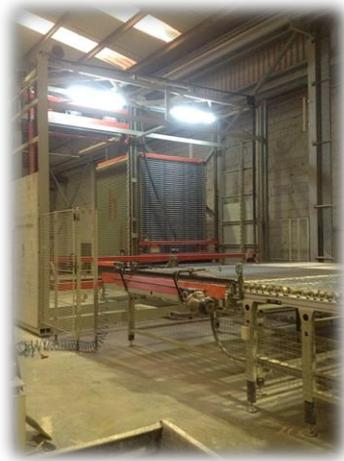
Esta es la zona de descarga de los boxes y la entrada al secadero horizontal y horno. Pero a esta zona no opera ningún trabajador de forma habitual, ya que solo se accede por fallo mecánico, por atasco de baldosas o para entrar pruebas de baldosas a mano. Por esto no es necesario respetar el mínimo marcado por la norma.
