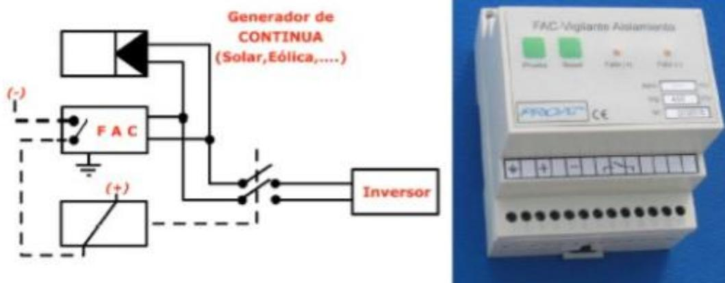
Ilustración 55: Vigilante de aislamiento y esquema de conexión.
