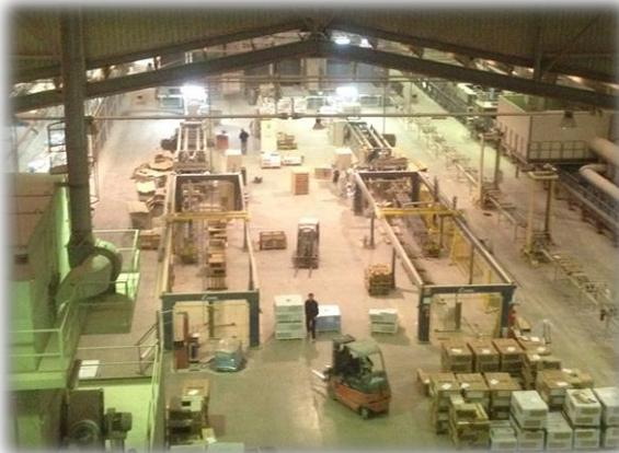
En la zona de clasificación y packaging actualmente ya no se realiza nada a mano debido a los sistemas de visualización artificial, máquinas de empaquetar y robots apiladores. Pero por si falla la máquina de visualización artificial, hay unos sitios específicos para clasificar a mano donde es necesaria una iluminación muy elevada para detectar los efectos con facilidad y que el operador no fuerce la vista.
