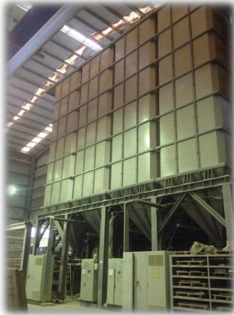
La zona de silos es una zona en la cual solo se accede a la caja de control que se ve en la parte inferior de ellos para controlar a que silo se carga o de que silo se descarga.
