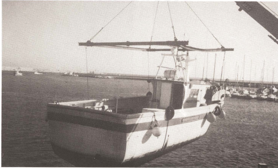
Embarcación de pesca izada mediante una grúa para su reparación.
