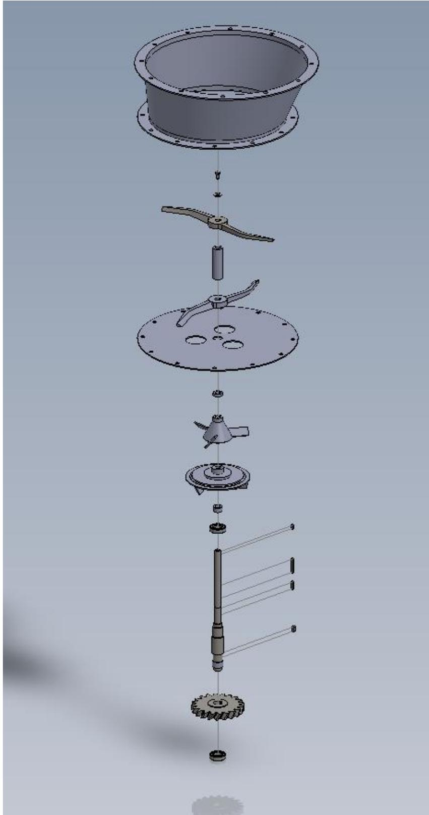
*Imagen 19: Vista explosionada del sistema de palas mejorado.*
