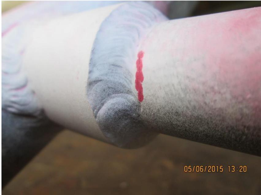
*Imagen 70: Fisura revelada en soldadura por ensayo de líquidos penetrantes.*
