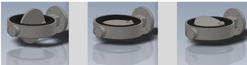
*Imagen 13: Representación en 3D del fallo de cierre de la válvula.*
