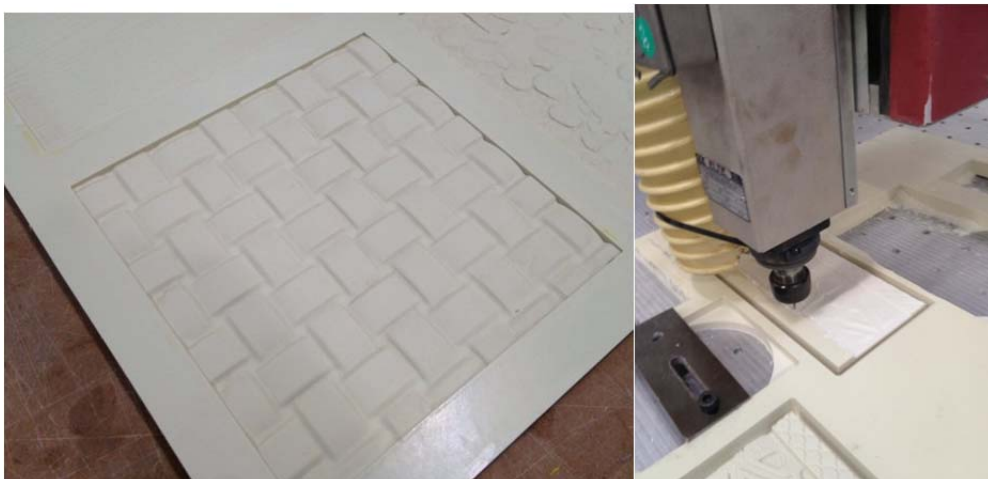
Fig 4.2 Fabricación molde de resina
