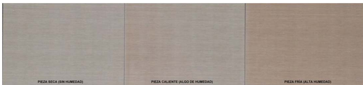
Fig 2.7 Cambio de tono por humedad
