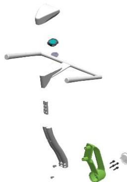
**Imagen 27.** Conjunto en explosión estructura primaria, estructura secundaria, estructura manillar, y asiento
