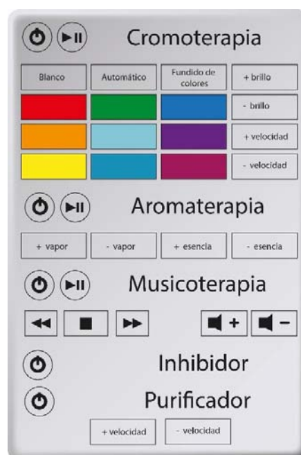
Figura 61. Esquema de la distribución de mandos en la botonera.
