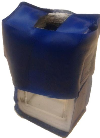
Fig. 10: cubeta de cuarzo aislada térmicamente con lana de roca
