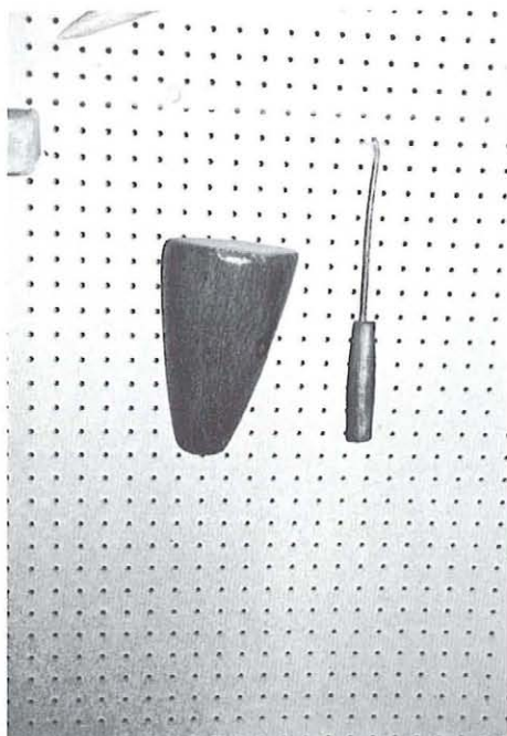
Patrón para montar "Les carettes" de las alpargatas y pasador para montar las cintas de sujetarlas. FUENTE MUSEO ETNOLÓGICO DE FADRELL
