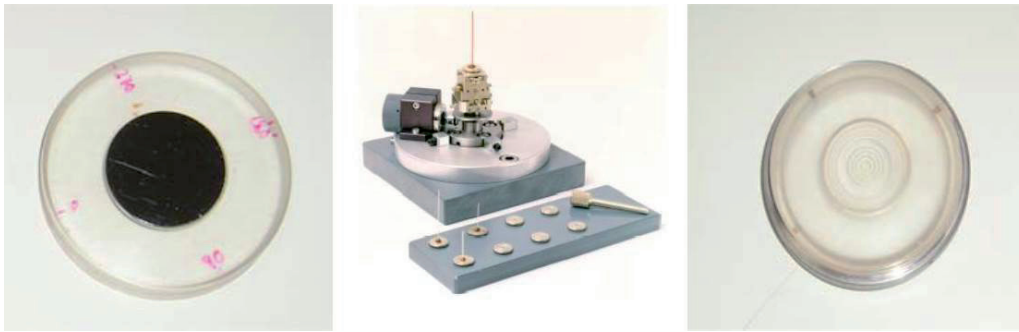
Figura 8. Ejemplos de portamuestras para el ensayo de difracción
