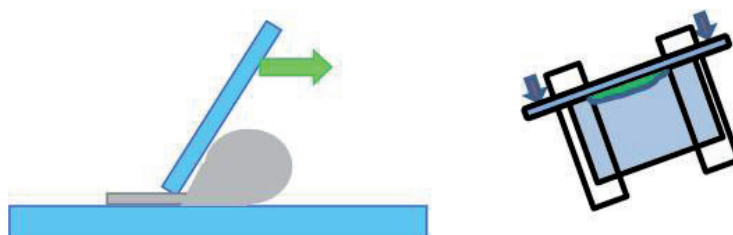
Figura 10. Representación de la técnica doctor blade
