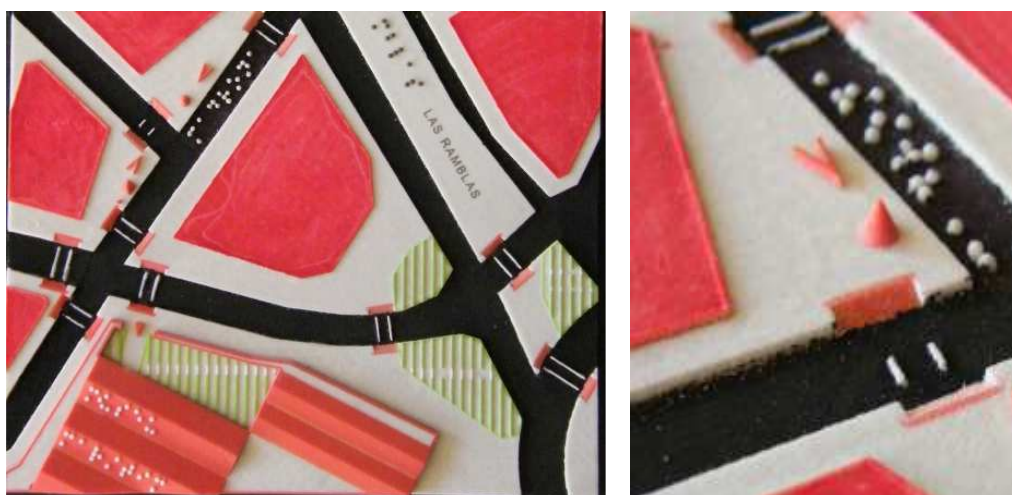
Figura 12. Imagen de plano táctil realizado con un equipo de impresión en 3D con polvo y aglutinante, en el que se observa la posibilidad de policromía de esta técnica y la rugosidad de la superficie resultante.
