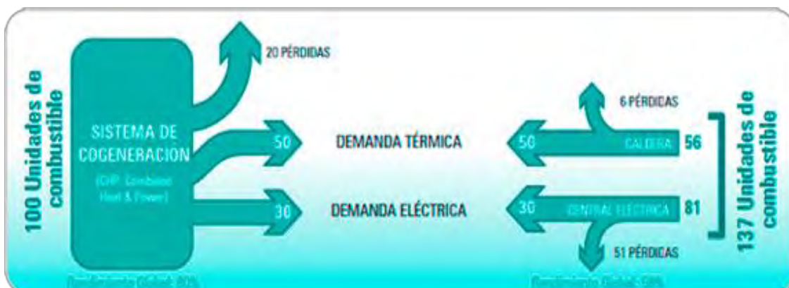
Figura 7.15 Esquema rendimiento de la cogeneración en viviendas.
