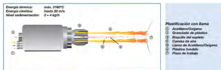
Figura 2.17. Esquema de proyección térmica oxifuel
