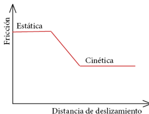
Figura 2.2. Tipo de fricción en función de la distancia
